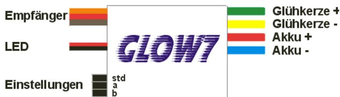
**Std:** Mit diesem Jumper kann man zwischen der automatischen Programmierung und einem fixen Standardwert frei wählen. ON = Automatische Programmierung, OFF = Standardwert
