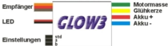
**Std:** Mit diesem Jumper kann man zwischen der automatischen Programmierung und einem fixen Standardwert frei wählen. ON = Automatische Programmierung, OFF = Standardwert
